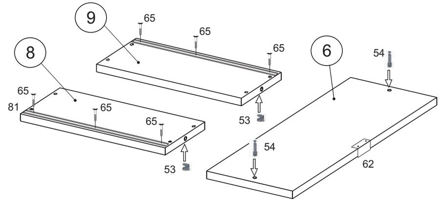
Направляющие устанавливать в соответствии с кернением. Допускается небольшое несоответствие кернения в связи с разными производителями направляющих.
