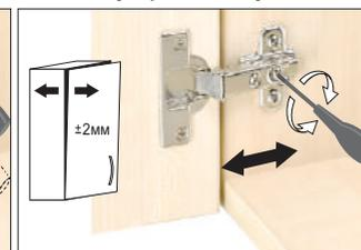
Ослабить крепежный винт и отрегулировать
